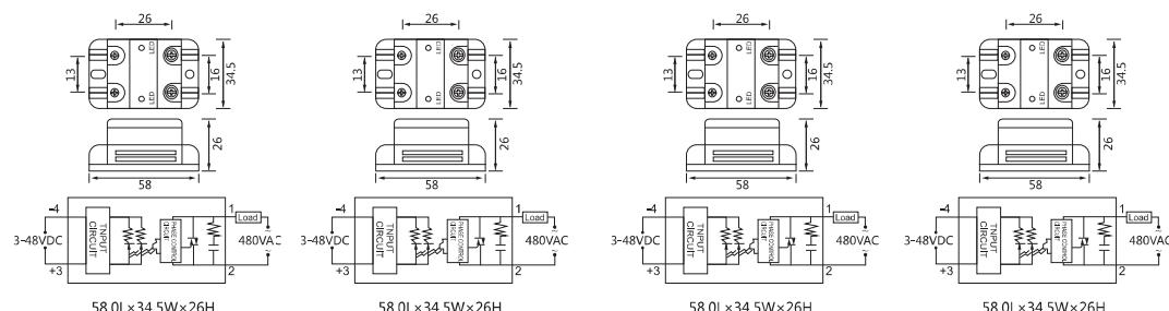
说明: 1、负载 10A, 必须装散热器, 40A 以上加风扇强冷或水冷。
